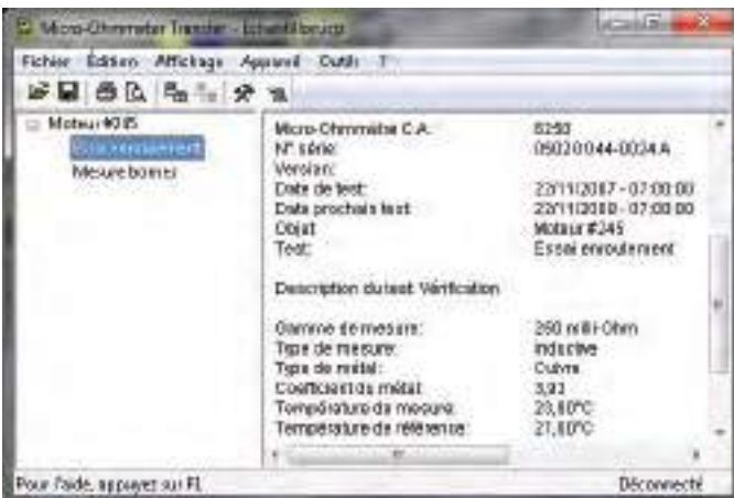
MODULO MOT Risultati dei test sugli avvolgimenti dei motori
